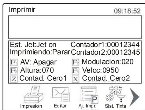
En el menú impresión se puede encontrar cuatro informaciones importantes: Est. Jet (Estado de Jet), Imprimiendo, Contador 1, Contador 2. También puede encontrar seis funciones: AV(alto voltaje), Modulación, Altura, Velocidad, Contador cero, Contador cero.
